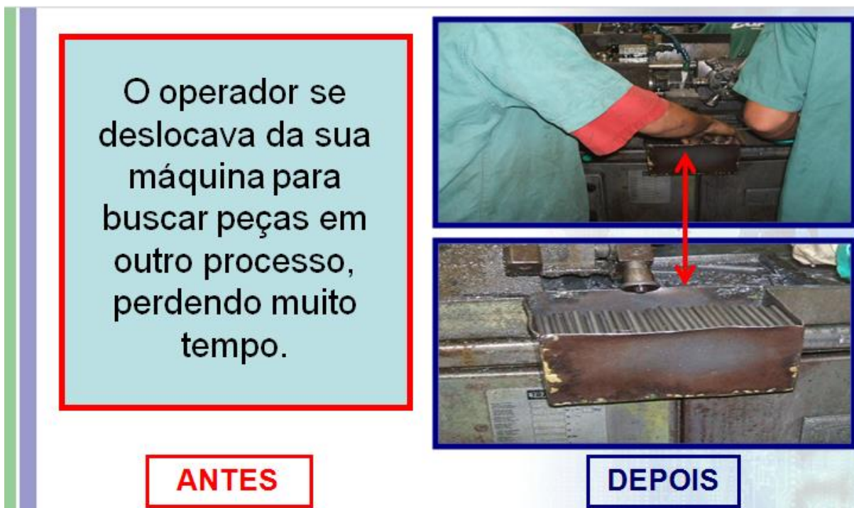
FIGURA 6 - Aproximação das peças para junto do operador
