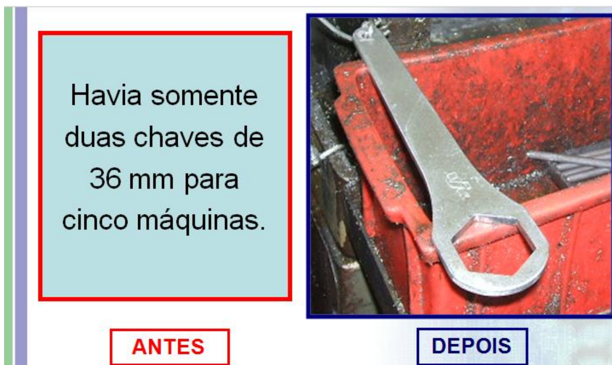
FIGURA 8 - Aproximação das ferramentas para junto do operador Fonte: dados da pesquisa
